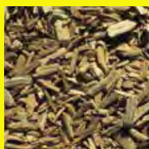
WOOD CHIPS Mechanisch zerkleinertes Holz (keine Holzwerkstoffe), ohne Rinde und Laubanteil Particle size 5 mm to 30 mm
